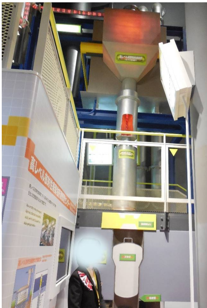
高レベル放射性廃棄物「ガラス固化体」制作工程を模型にて説明
